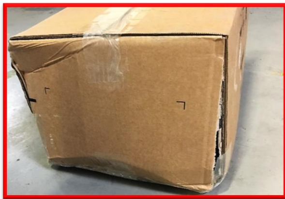
Bild 6/ Fig. 6: n.i.O. Karton/ not OK cardboard
