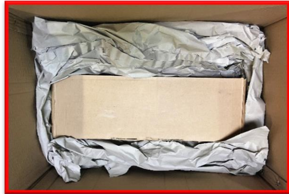
Bild 8/ Fig. 8: n.i.O. Verpackung/ not OK packaging
